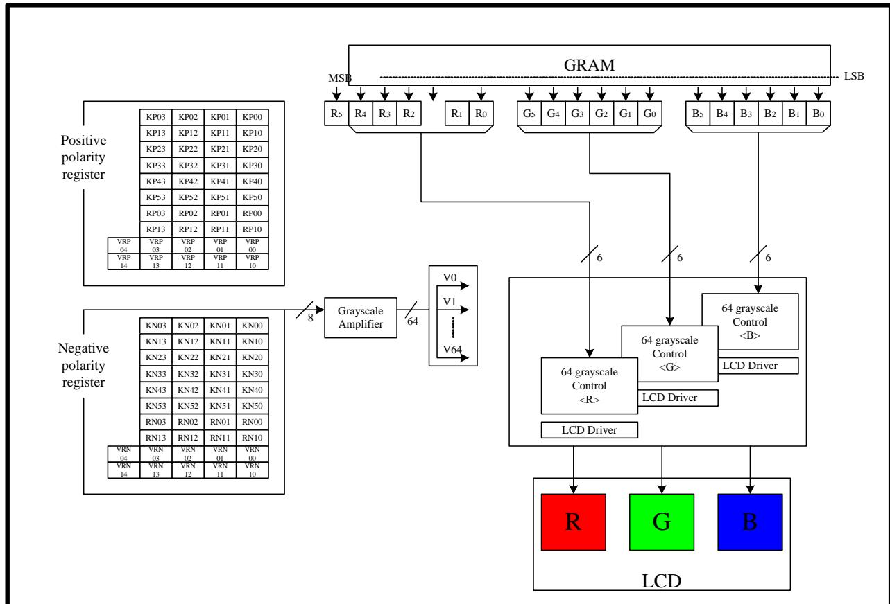
Figure33 Grayscale Mapping
